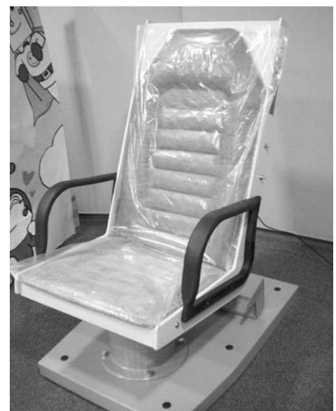
簡易型ホールボディカウンタによる検査
