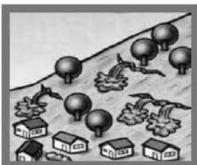
◆斜面から水がふき出る
