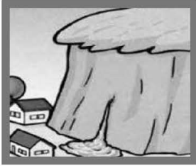
◆がけから水が湧き出ている
