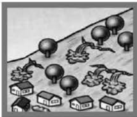
◆斜面から水がふき出る
