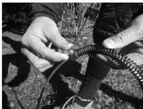
※ ねじを緩めるとバネの力が弱まり、自分で外すことができます。
